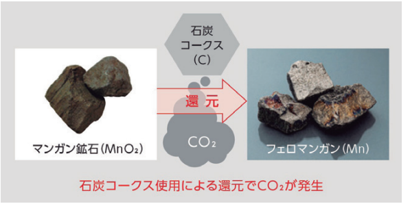
合金鉄製造における還元反応
